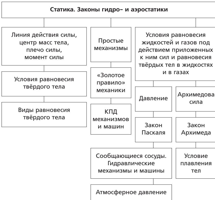
В § 31 рассматриваются различные виды простых механизмов (рычаг, подвижный и неподвижный блоки, наклонная плоскость). Из опыта с рычагом (см. рис. 124 учебника) можно сформулировать условие его равновесия. При обсуждении устройства и принципа действия блоков важно показать, что неподвижный блок не даёт выигрыша в силе, а позволяет только изменять направление действия силы. С помо-
